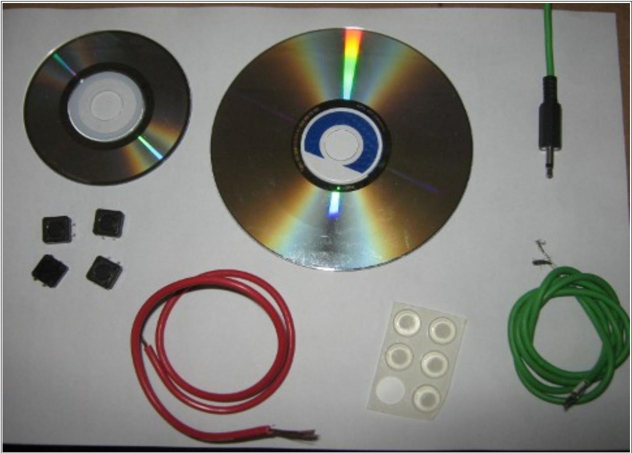
De izquierda a derecha y de arriba a abajo: CD chico, CD común, conector spika mono, 4 pulsadores de 12mm, cable multifilar, topes de silicona autoadhesivos, cable de cargador de XO roto.
