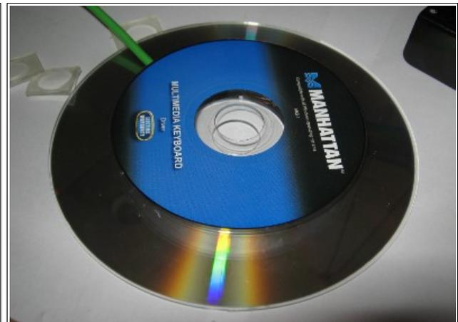
Retiramos el papel protegiendo el adhesivo de los topes, para pegar sobre estos el CD mas chico. Verificar que los centros de los Cds queden alineados ya que una vez adherido el CD a los topes no es sencillo ajustarlo.. A la izquierda se puede observar una vista de perfil y a la derecha una de arriba del pulsador casi terminado, todavía falta un detalle final.
