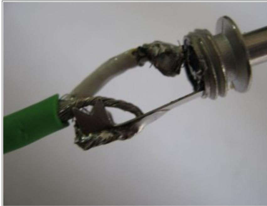
Soldamos con un poco de estaño para que no se suelten los cables. Hay que asegurarse que los cables no se toquen entre sí, si no, el pulsador no va a funcionar.
