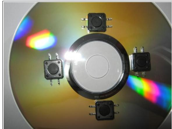
Colocamos una gotita de adhesivo en gel en cada esquina de la base de los pulsadores y los pegamos sobre la superficie no impresa del CD común, de modo que las patas no queden apuntando hacia el centro, como se muestra en la figura de la derecha. Dejamos secar un par de minutos, o hasta que los pulsadores queden firmes al CD.
