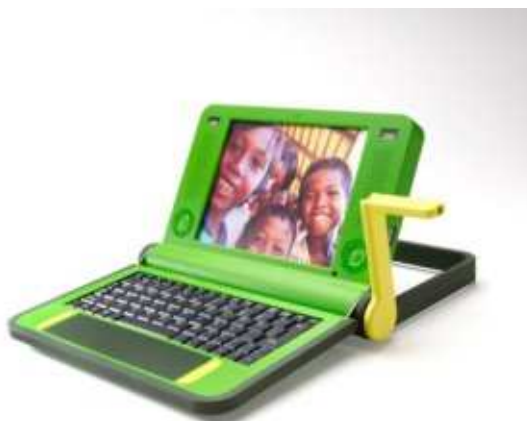
Figura 1.2: Prototipo inicial con manivela para cargar batería.
